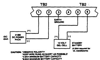
4140XM POWER PACK BATTERY CONNECTIONS
